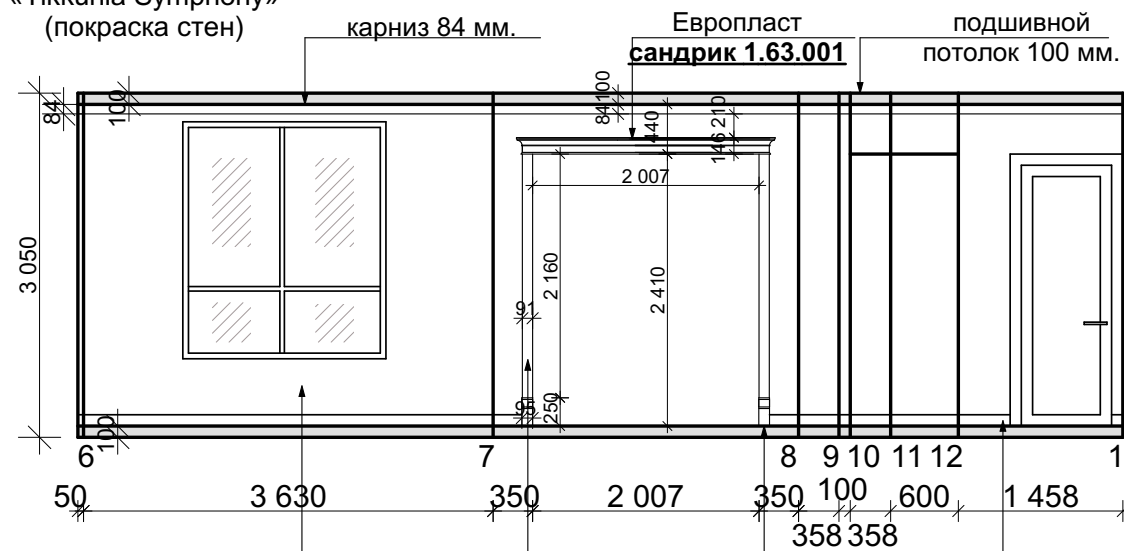
Колерная система «Tikkurila Symphony» (покраска стен) Европласт молдинг 1.51.347 Европласт база 1.54.010 плинтус 9,9 мм.
